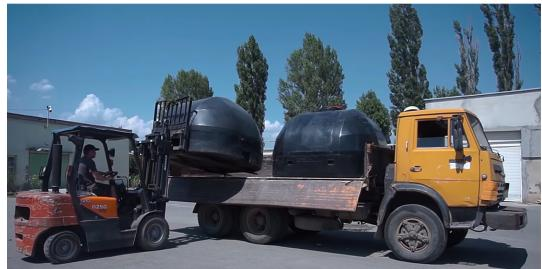
Емкость двухслойная, горизонтальная объемом 6500 литров, для хранения и перевозки пищевых и технических жидкостей, а также для хранения и перевозки Карбомидно-Аммиачной Смеси (КАС). Емкость КАС можно закрепить на кузов автомобиля для осуществления перевозки жидкостей или удобрений. В конструктиве емкости присутствуют два паза для ремней крепления емкости с кузовом автомобиля, также крышка емкости дотирована дышащим клапаном, для сброса лишнего давления которое может появиться в емкости.
