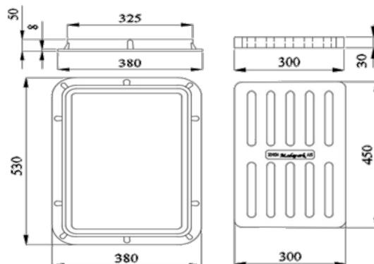
Решетка композитная с рамой с классом нагрузки A15.
