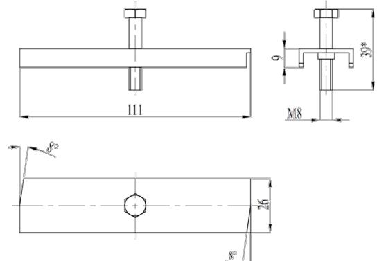
Крепеж, из оцинкованной стали, для крепления решеток с лотками водоотводными BetoMax Basic DN100.
