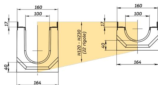
**Лоток водоотводный фибробетонный серия PRO DN100 с внутренним уклоном H120-230мм и решеткой чугунной D400 (1000x160x120-230мм)**
