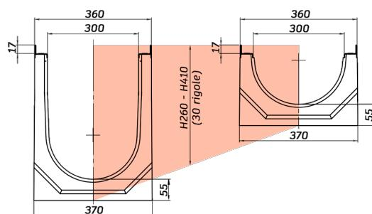
**Лоток водоотводный фибробетонный серия PRO DN300 с внутренним уклоном H260-410мм и решеткой чугунной D400 (1000x360x260-410мм)**
